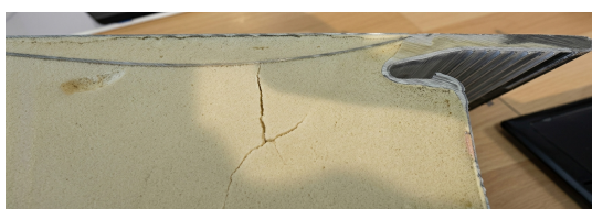
Fig. 2: Exemplo de rotura do poliuretano
