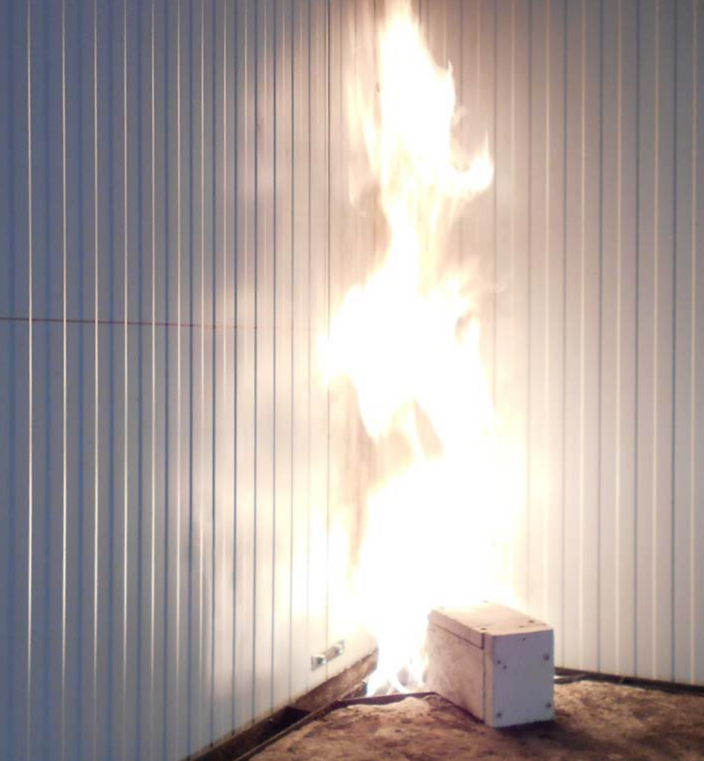
Ensaio do elemento isolado em combustão (SBI)
